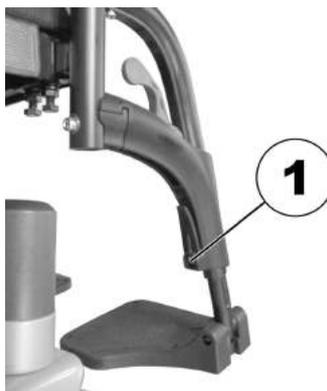
1. Schraube (1) mit dem Innensechskantschlüssel lockern, aber nicht ganz herausdrehen.
