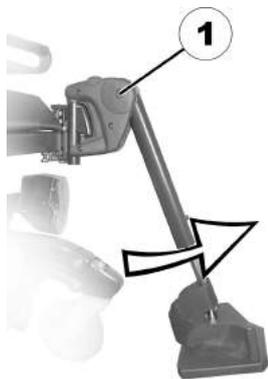
3. Schraube (1) mit dem Innensechskantschlüssel lösen und Fußstütze nach oben schwenken, um an den Gummipuffer heranzukommen.
