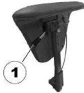
Der Hebel (1) zur Verstellung des Rückenwinkel befindet sich auf der gegenüberliegenden Seite vom Fahrpult unter der Armllehne. Ist das Fahrpult beispielsweise rechts montiert, befindet sich der Hebel links.
