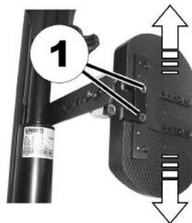
1. Schrauben (1) mit dem Innensechskantschlüssel lösen.
