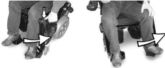
Beinstütze entriegeln und nach außen schwenken.
