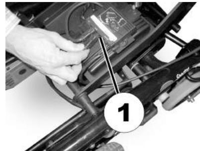
Fahrpultkabel unter dem Sitzträger einführen und mit der Elektronik verbinden.
