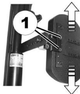
1. Schrauben (I) mit dem Innensechskantschlüssel lösen.
