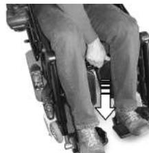
1. Wadenplatte gerade nach unten drücken. Die Wadenplatte ist entriegelt.
