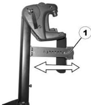
1. Mutter (I) mit dem Gabelschlüssel lösen und entfernen.
