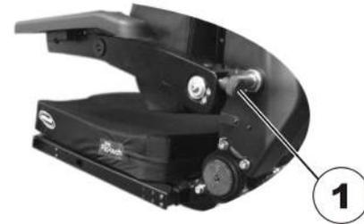
Die Knebelschraube zur Verstellung des Armlehnenwinkels (1) lösen.
