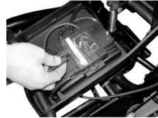
Stecker des Fahrpultkabels aus der Elektronik herausziehen.
