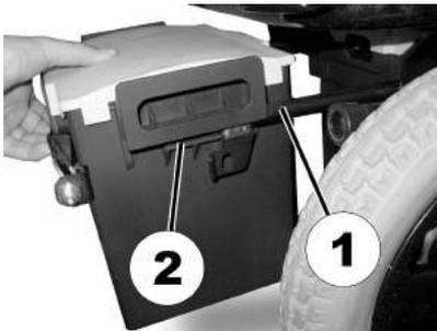
Beim Einsetzen der Batteriekästen darauf achten, dass die Führungsstangen (1) genau in die dafür vorgesehenen
