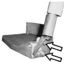
1. Beide Feststellschrauben der Fußplatte mit dem Innensechskantschlüssel lösen.
