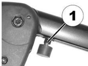
6. Kontermutter (1) mit dem Gabelschlüssel lösen.
