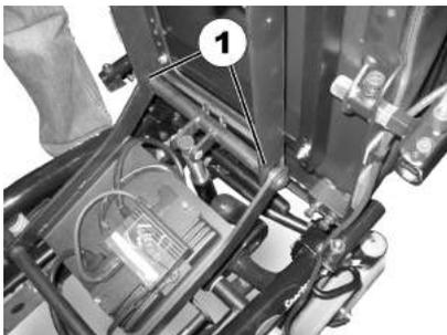
Beim Zusammenbau darauf achten, dass die Führungsgabeln (1) des Sitzes im vorderen Bereich genau auf die Haltestange greifen.
