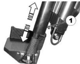
1. Schraube (I) mit dem Schraubenschlüssel lösen.
