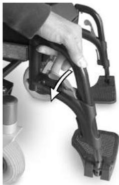
1. Entriegelungshebel nach innen oder außen drücken. Die Beinstütze ist entriegelt.
