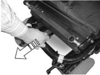
Sitz entriegeln (der Entriegelungsgurt befindet sich hinten unter dem Sitz).
