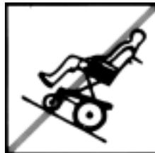
Keine Gefällstrecken mit hochgefahrenem Lifter befahren!
