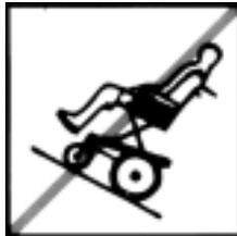
**Keine Gefällstrecken mit hochgefahrenem Lifter befahren!**
