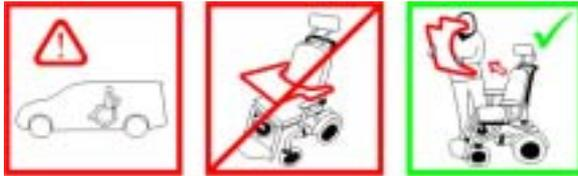
Falls der Elektrorollstuhl mit einem Tisch ausgestattet ist, muss dieser zum Transport in einem Fahrzeug unbedingt entfernt und sicher verstaut werden!
