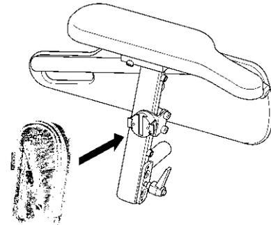
Der Adapter lässt sich in 90°-Schritten drehen. Dadurch haben Sie vier Einschubrichtungen zur Auswahl. Sehen Sie die Installationsanleitung, die Sie bei Ihrem Invacare®-Fachhändler oder direkt bei Invacare® erhalten.
