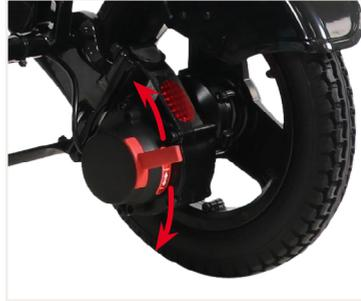
Abbildung 14: Aktivieren oder Deaktivieren der Feststellbremsen
