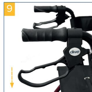
Zum Feststellen / Parken des Rollators beide Bremsgriffe nach unten drücken, bis sie hörbar einrasten **(Bild 9)**! Zum Entriegeln der Bremse beide Bremsgriffe wieder nach oben ziehen, bis sie entriegelt sind (Bremsgriffe sind in mittlerer Position). Die Bremswirkung kann durch die Abnutzung der Reifen beeinträchtigt werden. Deshalb Bremswirkung regelmäßig überprüfen.
