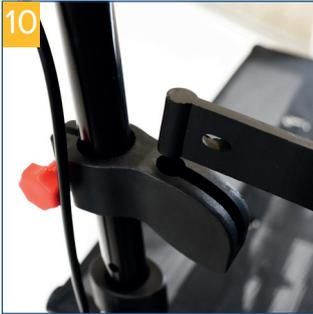
**Montage Rückenbespannung:** Die Bespannung positionieren, indem die Befestigungen auf beiden Seiten in die Führungen der Halterungen eingeführt werden, die sich auf der Höhe der Griffe befinden (**Bild 10**).
