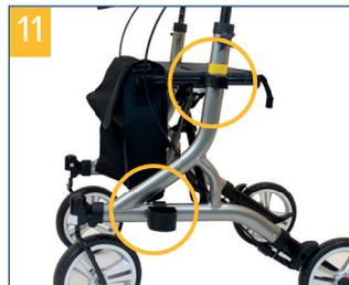
Den oberen Stockhalter unterhalb des gelben Reflektors an den Rahmen einclippen. Den Becher an den unteren Rahmen fixieren (**Bild 11**).
