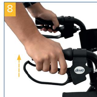
Zum Bremsen während des Gehens mit dem Rollator beide Bremsgriffe mit den Händen nach oben ziehen **(Bild 8)**. Immer langsam und gleichmäßig mit beiden Händen bremsen.
