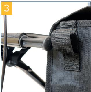
Die Tasche wird mit den Ösen an den Rahmenrohren eingehängt **(Bild 3)**.
