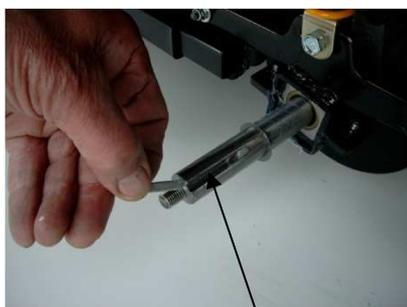
Achtung Hinterrad, Stahlpassfeder beachten. Die überträgt das Drehmoment von der Achse auf das Rad und liegt nur lose in der Nute. Achtung, kann leicht verloren gehen.
