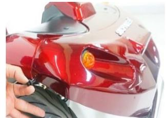
6. Ziehen Sie die Schraube für die vordere Lichtabdeckung und den Stoßfänger fest.
