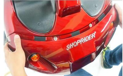
4. Der LED-Scheinwerfer muss in die vordere Lichtabdeckung eingesetzt werden.
