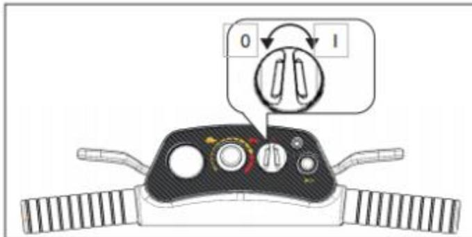
Anmerkung: Wenn die Statusanzeige beim Einschalten des Elektromobils blinkt, liegt möglicherweise eine schwache Batterie oder ein Fehler vor. Bitte schalten Sie das Elektromobil aus und laden Sie es auf oder wenden Sie sich an Ihren autorisierten Serviceanbieter.
