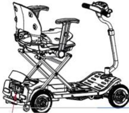
Verriegelung des hinteren Batteriekastens
