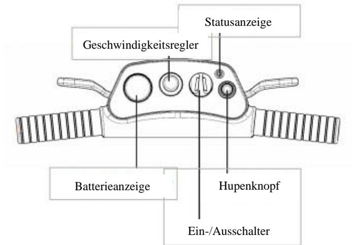
Stecken Sie den Schlüssel ein und drehen Sie nach rechts auf "I", dann wird das Elektromobil eingeschaltet.
