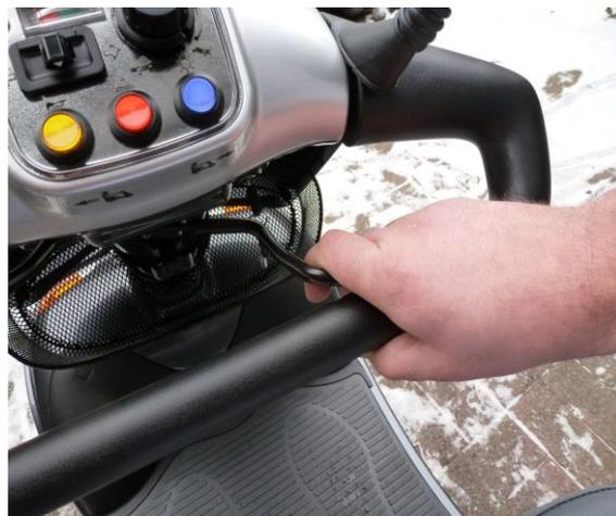
Warnung: Ziehen oder Drücken Sie nicht an beiden Hebelarmen gleichzeitig, weil so die Fahrhebelmechanik beschädigt wird.
