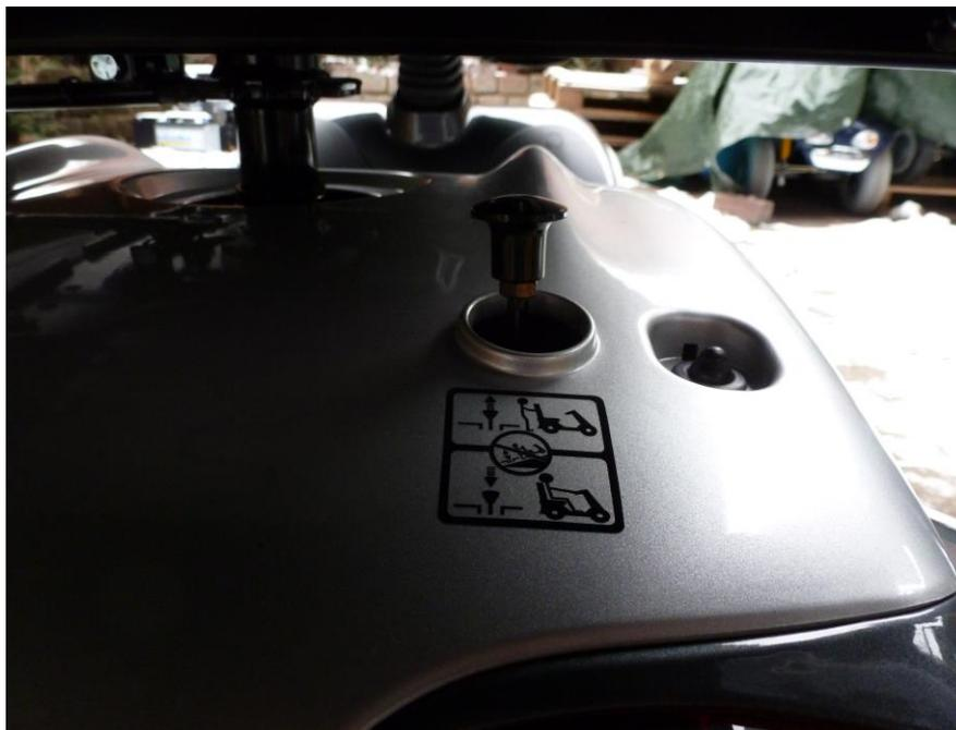
Einlegen des Freilaufs: Der Freilauf wird eingestellt durch einen schwarzen Knopf, der rechts hinten aus der Karosserieabdeckung herausragt. Um Ihr Elektromobil im Freilauf zu fahren, ziehen Sie den Knopf ca. 3cm nach oben. Jetzt können Sie Ihr Elektromobil mit Leichtigkeit schieben. Um den Antrieb wieder einzukuppeln, drücken Sie den schwarzen Knopf einfach nach unten. Jetzt können Sie das Fahrzeug wieder benutzen.
