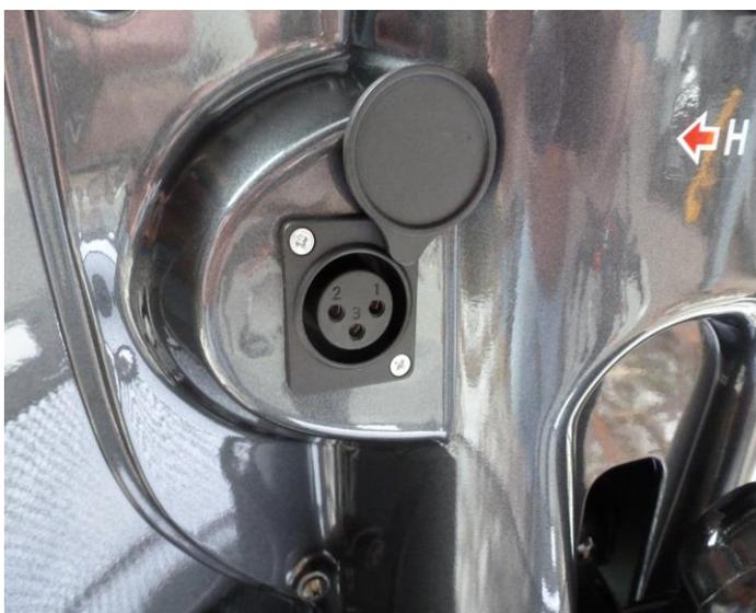
3. Verbinden Sie das Netzkabel des Ladegeräts mit einer normalen Haushaltssteckdose. Falls es sich um eine geschaltete Steckdose handelt, schalten Sie die Stromzufuhr zur Steckdose ein. Nach Anschluss an die Netzspannung leuchtet die rote Netzkontrolllampe des Ladegeräts. Ein paar Sekunden später leuchtet dann die gelbe Ladekontrolllampe auf und das Ladegerät beginnt mit der Grundladung der Batterien.
