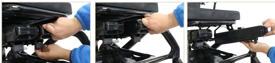
Abbildung 2: Den Akku entnehmen: Ziehe und halte den Klipp unterhalb des Akkugriffes nach vorne und ziehe dann den Akku am Griff nach vorne heraus.
