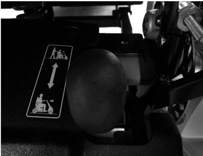
Stellen Sie den Hebel der Motorarretierung auf Fahrbetrieb. Motor und Getriebe werden verbunden. Das Elektromobil ist nun fahrbereit.
