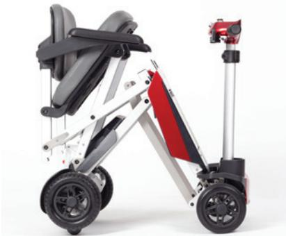
2. Halten Sie die Lenksäule mit einer Hand und den Sitz mit der anderen Hand fest und ziehen Sie sie auseinander, um das Elektromobil zu entfalten.
