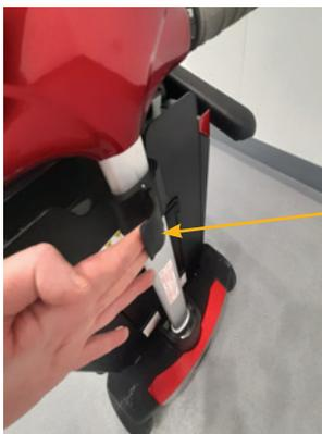
7. Ziehen Sie an der Verriegelung (links mit Pfeil markiert) an der Lenksäule, um sie zu entriegeln. Durch Ziehen an der Lenksäule kann die gewünschte Höhe der Bedienelemente eingestellt werden. Schließen Sie den Klemmhebel, um die Lenksäule zu arretieren.
