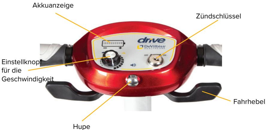
Das Elektromobil verfügt über eine Akkuanzeige mit LEDs (rechts).
