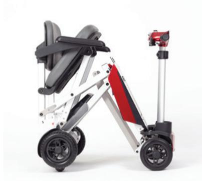
4. Drücken Sie das Fahrgestell des Elektromobils nach unten, um den Faltmechanismus zu verriegeln.
